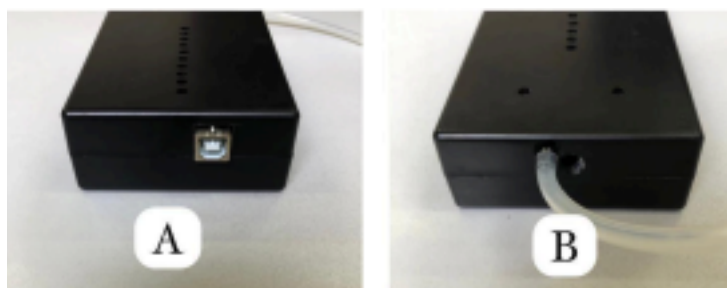
Figura 1 – Hardware Mano-BD. A: conexão Universal Serial Bus (USB); B: conexão com látex e peça rígida (bocal).
